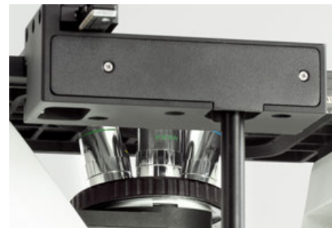
L'applicazione delle manopole di messa a fuoco x/y è possibile a destra e a sinistra
