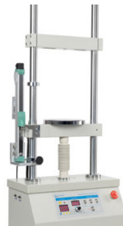
Banco di prova motorizzato incl. sistema di misurazione della lunghezza LD
