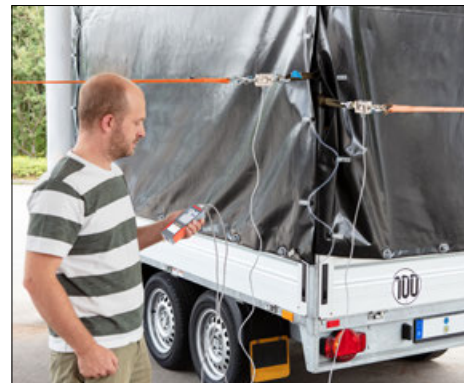
Misurazione di forze in diverse direzioni di trazione o compressione possibile con un solo dispositivo di misurazione
