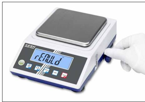
Il circuito di calibrazione interno tramite manopola laterale garantisce la massima precisione e rende indipendenti dal luogo di installazione
