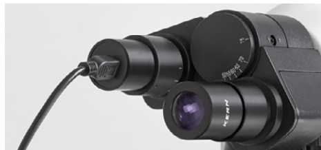
Fotocamera oculare fissata al tubo
