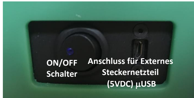
Abb. 2: Netzteilanschluss und Hauptschalter
