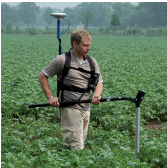
MAGNEX® con data logger EPAD® e sistema DGPS OMNISTAR
