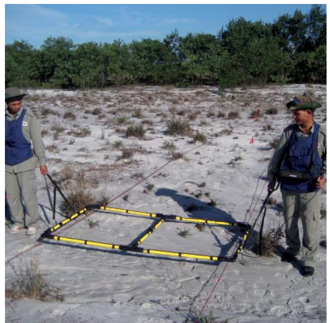
EBINGER UPEX® Sistema di acquisizione dati (data logging) e di localizzazione.
